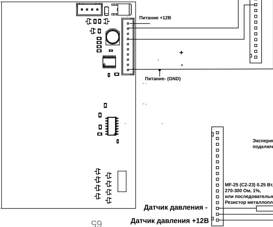
Экспериментальное подключение датчика давления OWEN
